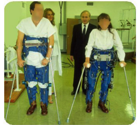
Figure 12 - Technique de neurostimulation intra-neurale destinée à redonner aux patients paraplégiques une fonction motrice avec exosquelette motorisé pour restaurer la marche.
