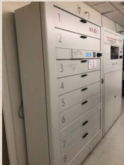
Exemple de machine ScrubX, qui permet de délivrer sa tenue de bloc après vérification du numéro d'identification et du mot de passe.
